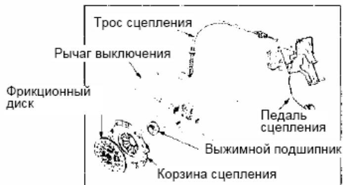
Рис. 2-8 Дисковое сухое сцепление
