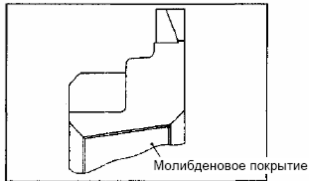
Рис. 3-20 Кольцо синхронизатора с молибденовым покрытием
