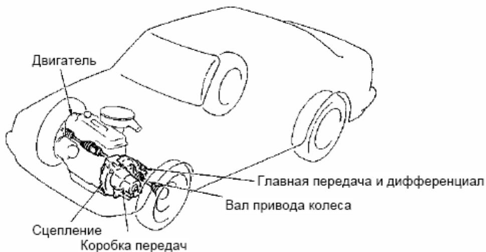
Рис. 1-2 Трансмиссия переднеприводного автомобиля с передним расположением двигателя
