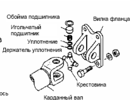
Рис. 4-5 Устройство карданного шарнира неравных угловых скоростей
