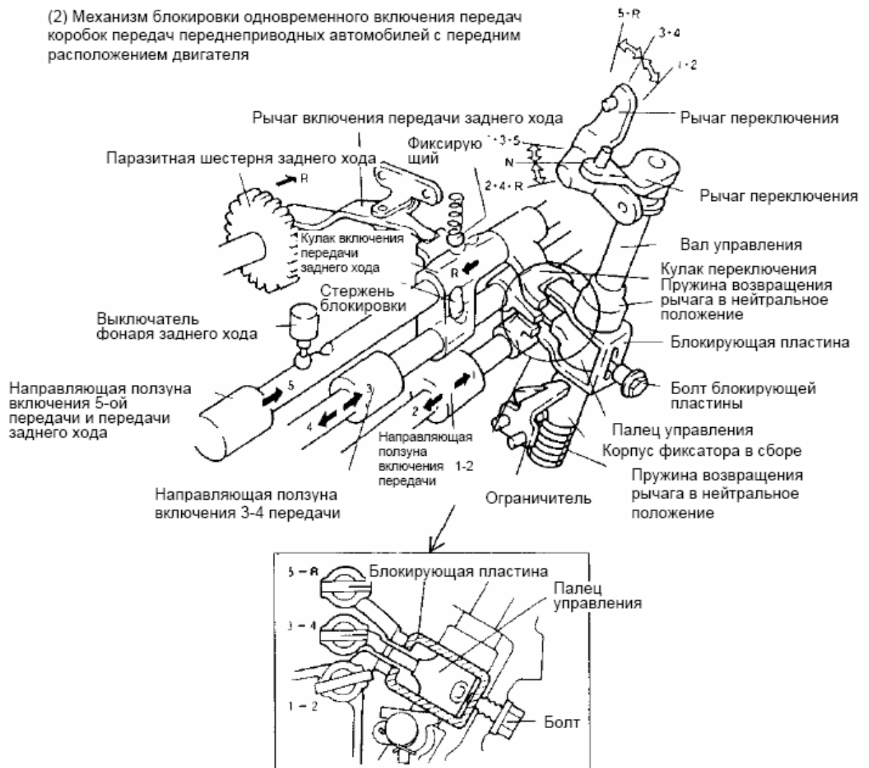
Рис. 3-13 Механизм блокировки одновременного включения передач
