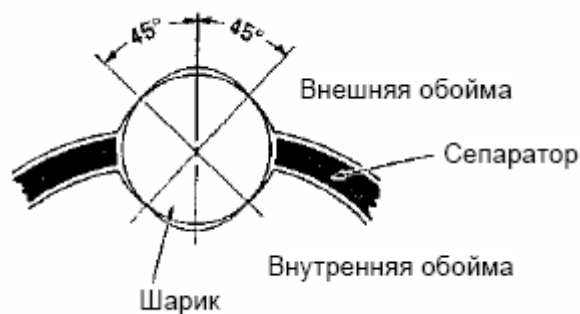
Рис. 5-8 Взаимодействие шариков, внешней и внутренней обоймы
