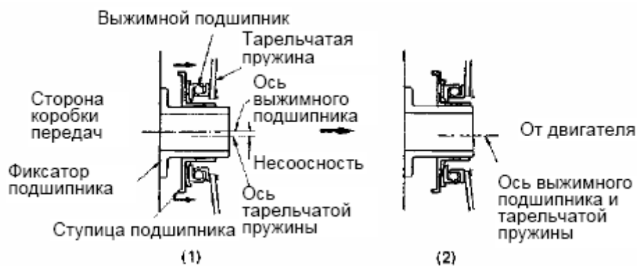
Рис. 2-13 Работа самоцентрирующего выжимного подшипника
