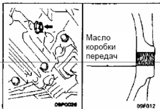
Рис. 8-6 Проверка уровня масла в коробке передач
