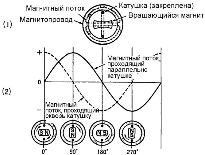
Рис. 8.2 Основной принцип генерирования тока в генераторе
