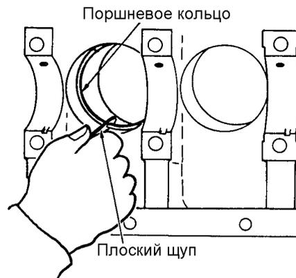
Рис. 11.56. Проверьте зазор между концами каждого поршневого кольца
