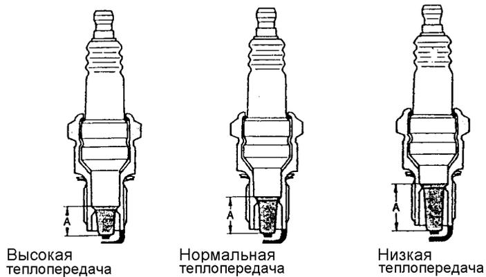
Разница в конструкции зависит от тепловой характеристики свечи зажигания
