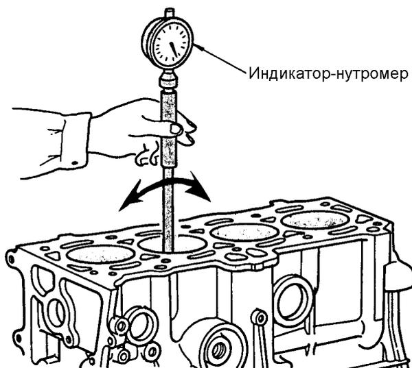
Измерение внутреннего диаметра цилиндра
