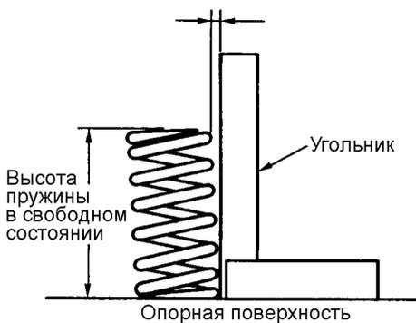
Рис. 11.34 Измерение неперпендикулярности пружины
