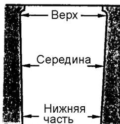
Характерный вид износа цилиндра и точки измерения
