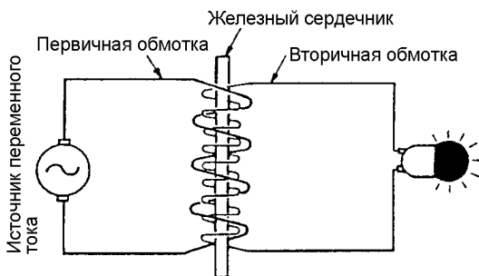
Рис.2-71Т Взаимная индукция катушки
