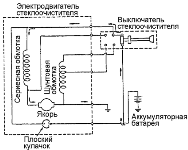
Рис.3-18Т Выключатель стеклоочистителя в позиции большой скорости движения щеток
