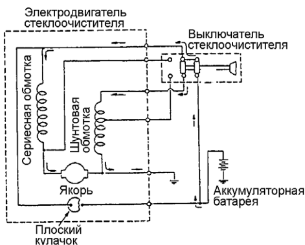
Рис.3-17Т Выключатель стеклоочистителя в позиции малой скорости движения щеток
