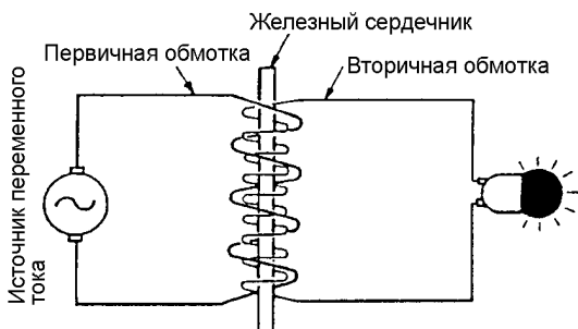
Рис.2-71Т Взаимная индукция катушки
